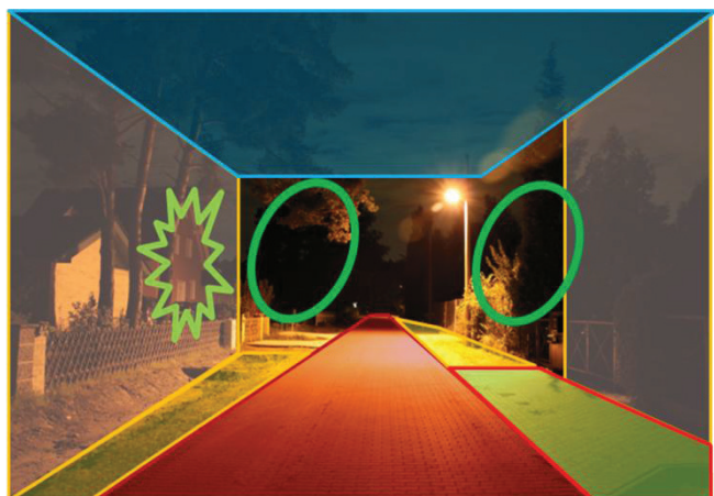
Abbildung 1: Einteilung des Blickfeldes in farblich gekennzeichnete Nutzflächen. Diese sind unterschiedlich zu beleuchten (Erläuterung zu Kreisen und Stern siehe Text).
